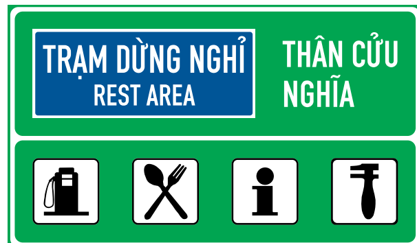
Hình 14 - Biển số IE.456b chỉ dẫn hướng rẽ đến trạm dừng nghỉ
