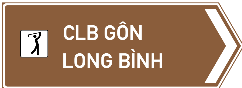
d) Biển số IE.461d chỉ dẫn hướng rẽ vào khu giải trí
