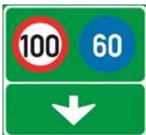
Hình 9b - Biển chỉ dẫn bắt đầu đường cao tốc phân làn đường có tốc độ khác nhau
