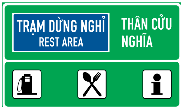
Hình 14 - Biển số IE.456b chỉ dẫn hướng rẽ đến trạm dừng nghỉ
