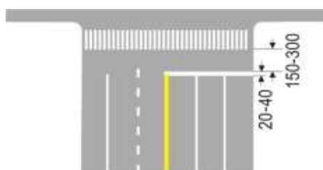
Hình G.47 - Vị trí vạch dừng xe ở nút giao có vạch người đi bộ qua đường
