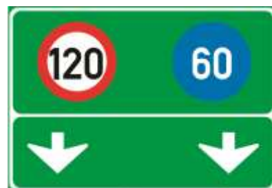
Hình 9b - Biển chỉ dẫn bắt đầu đường cao tốc phân làn đường có tốc độ khác nhau
