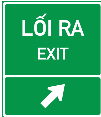
Hình 33 - Biển số IE.474 chỉ dẫn lối ra
